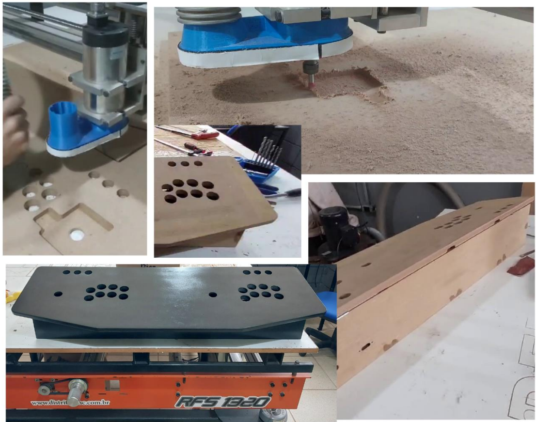
Figura 1 - Processo Usinagem CNC e montagem da caixa
