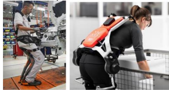
Figura 7 – Comparação entre exoesqueleto passivo e ativo.
