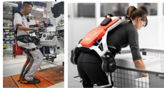
Figura 7 – Comparação entre exoesqueleto passivo e ativo.
