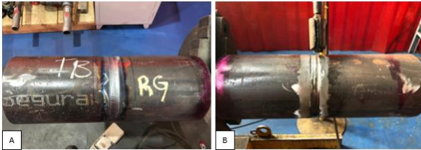
Figura 5: Soldagem com passes filetados A) Amostra 1; B) Amostra 2
