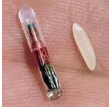
Figura 4 - Chip RFID comparado com um grão de arroz
