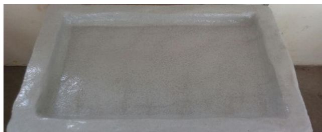
Figura 11- Membrana Poliuretano em Tempo de Cura Consolidado
